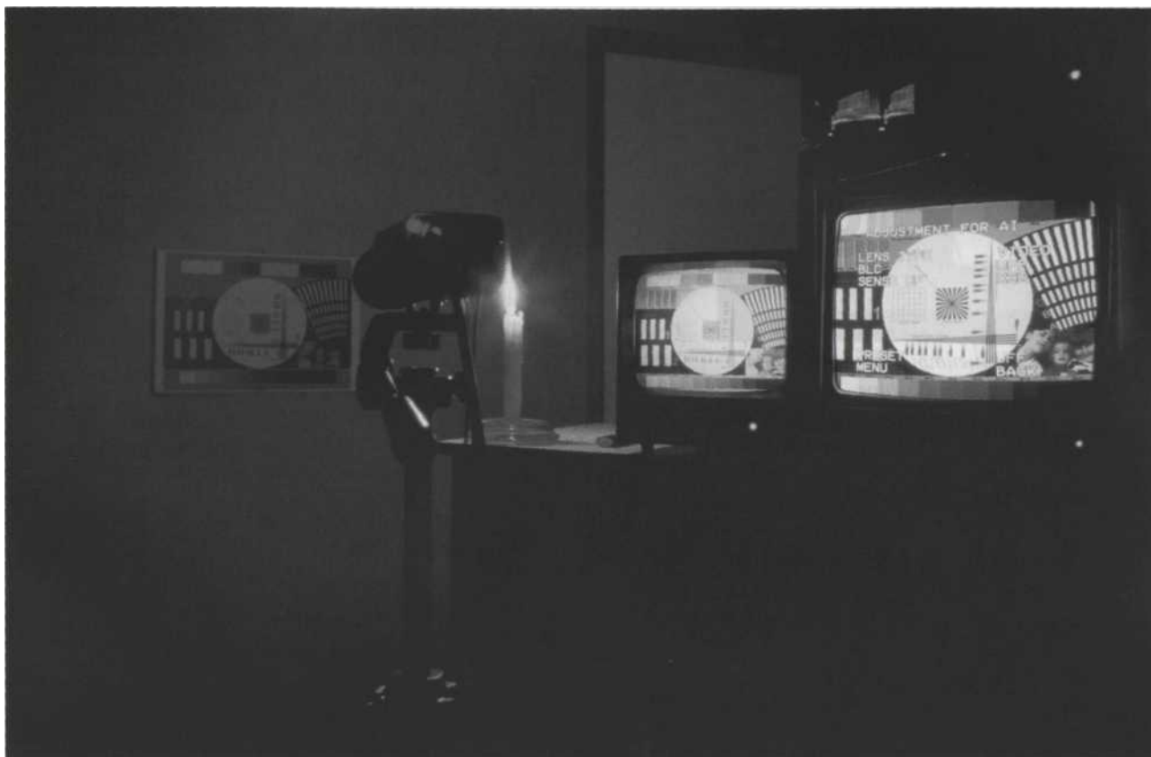
Рис. 14.7. Для оценки работы телекамеры при низкой освещенности вы можете использовать обычную свечу, расположенную на расстоянии 1 м от испытательной таблицы
